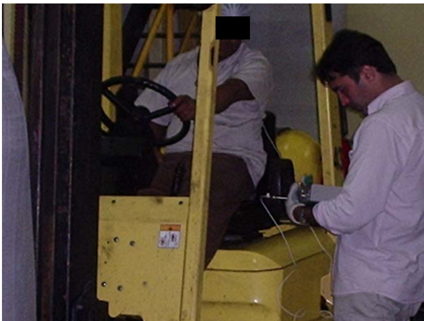
Figura 4 – Detalhe da medição do Operador de Empilhadeira / Galpão da Empresa
