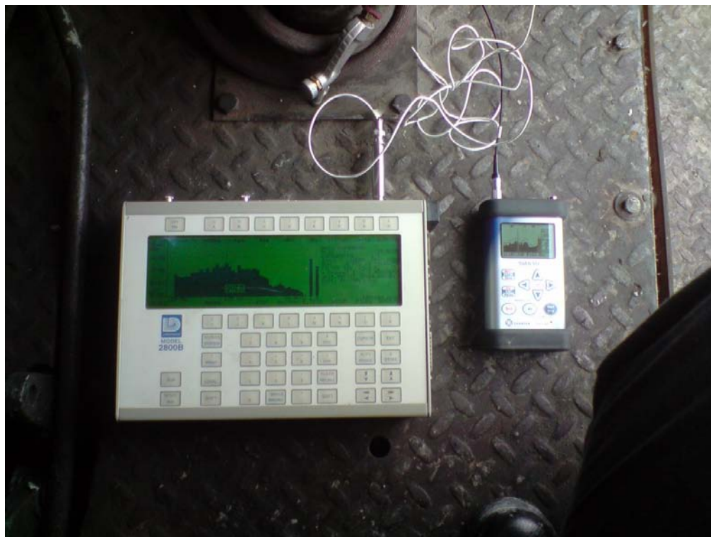
Fig. 12 – Detalhes da instrumentação utilizada nos estudos de vibração no corpo humano.
