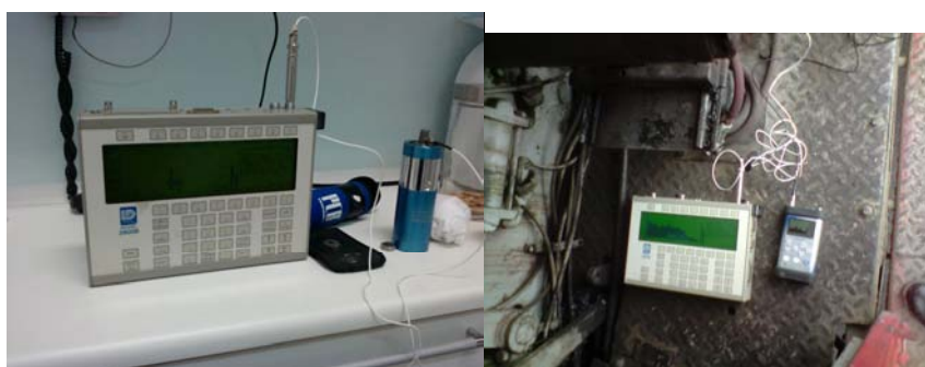
Fig. 5 – Calibração dos Instrumentos antes e após as medições: LD 2800 e Svantek 958.
