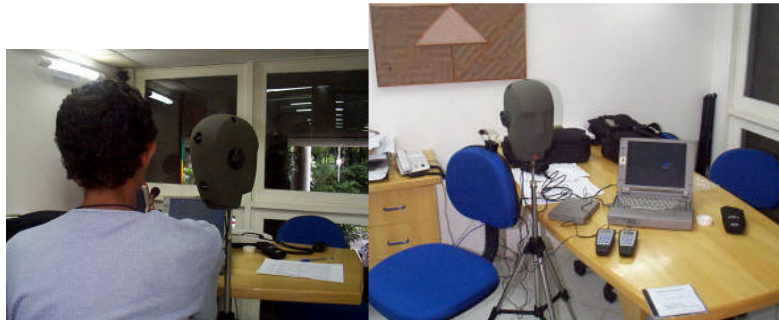
Figura 2 – Comparação do NPS na altura do ombro do operador (FUNDACENTRO) com a medição realizada com a cabeça artificial.
